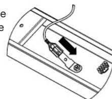
8. Montez la lampe ultraviolette G30T8/OF fournie dans la douille dans le sens indiqué ci-dessus.
