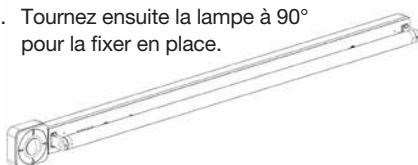
2. Sortez les douilles du boîtier et fixez-les dans les rainures à chaque extrémité du boîtier.
