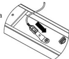
8. Monte la lámpara ultravioleta G30T8/OF proporcionada en el portalámparas en la dirección que se indica arriba.
